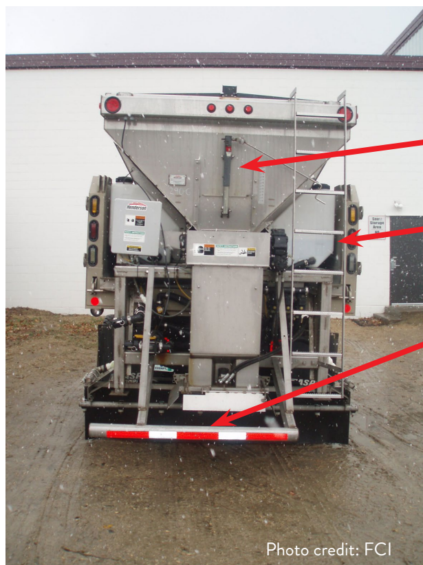
Figura 26: Camión equipado para prehumedecimiento.
