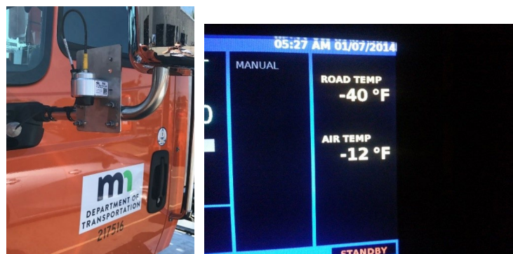
Figura 15: Sensor de temperatura del pavimento montado en el espejo retrovisor y pantalla dentro de la cabina del vehículo.
