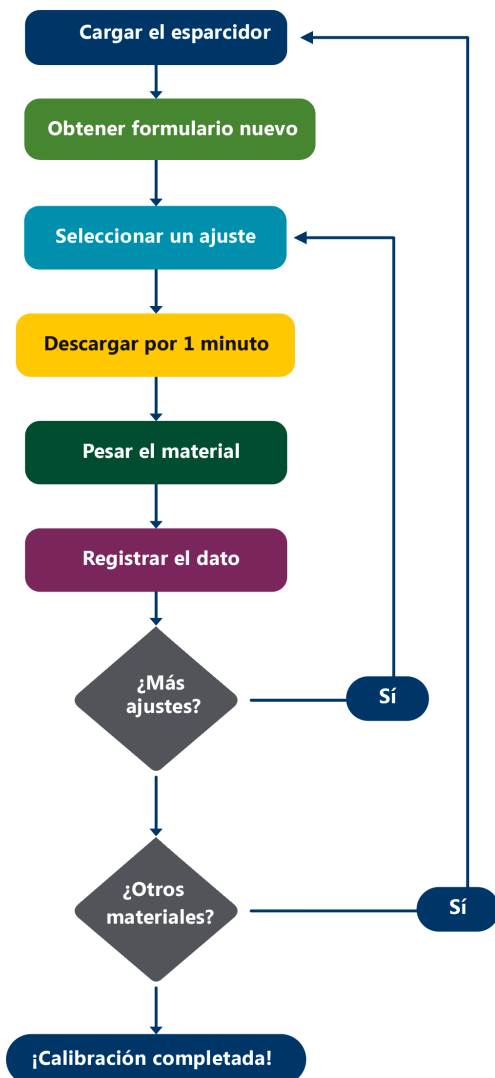
Figura 19: Pasos para calibrar un sistema con sinfín o banda transportadora
