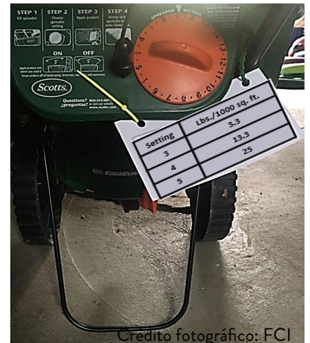
Figura 18: Tarjeta de calibración amarrada con bridas a un esparcidor manual de empuje.
